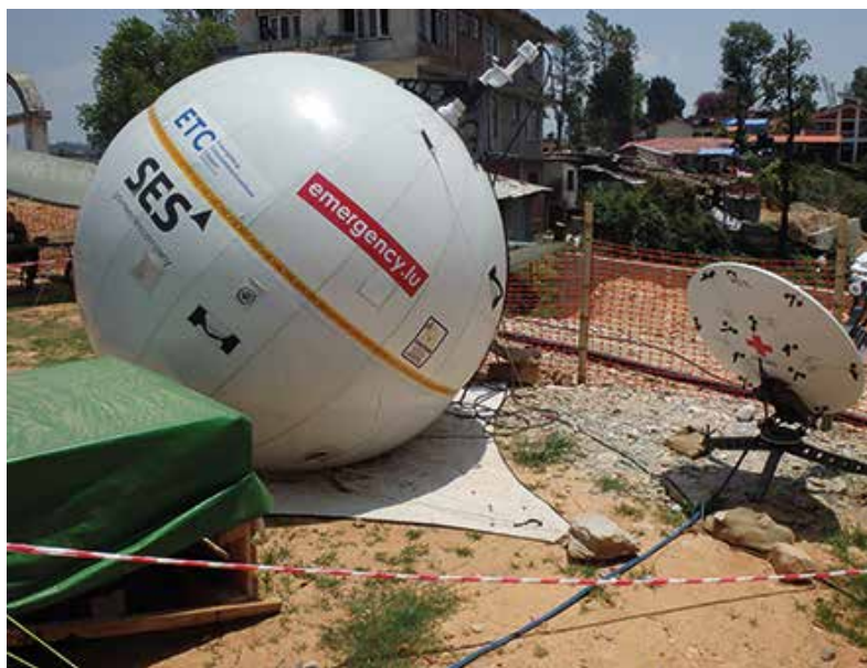
Två VSAT (Very Small Aperture Terminal) för internettillgång till hjälparbetet via geostationära satelliter.
