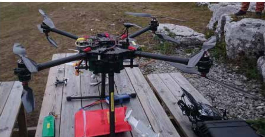
HF16. UAV presenterad som budgetalternativ till antennmätning med helikopter. Quadrocoptern som lyfter 2kg är utrustad med mätantenn, SDR-dongle, GPS, höjdmätare och en Raspberry Pi2 som hjärna med Wifi som länk till marken.
