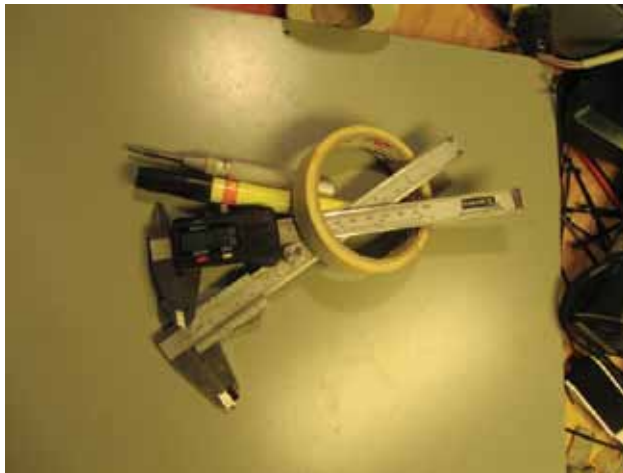
Uppifrån och ner : Automatisk körnare, märkpenna, digitalt skjutmått, klassiskt skjutmått samt över och under verktygen en rulle maskeringstejp.
