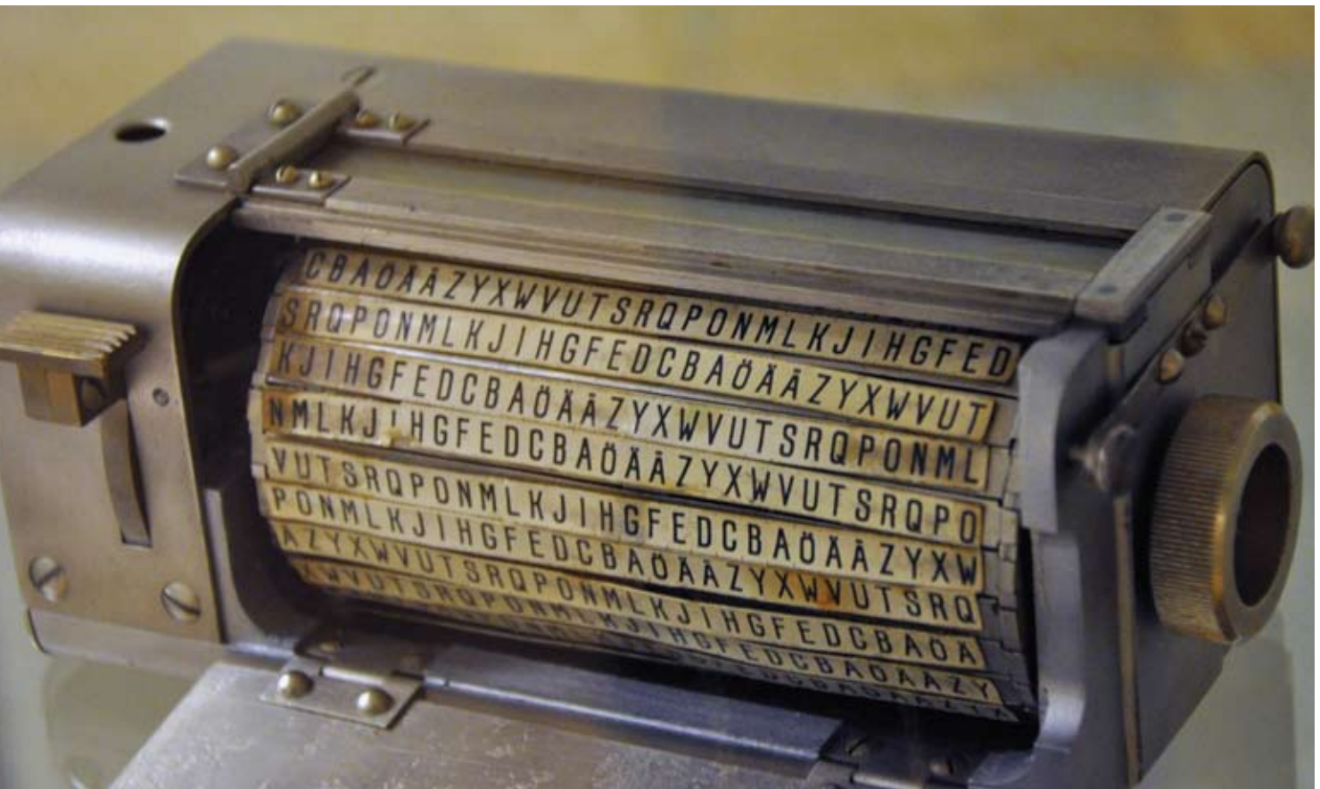
Kryptograf A-22 med "kedjedrift", utvecklad någon gång runt 1920.
