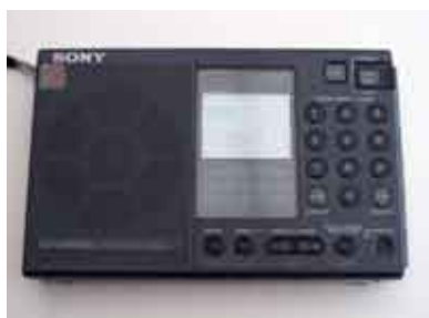
SONY-mottagare ICF-SW7600. Mottagaren har uttag för extra antenn. En enkel ferritantenn för mellanvågsbandet tillverkades och nu blev det genast bättre resultat.
