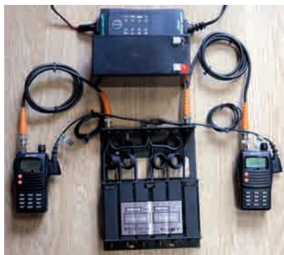
Bilden visar vad som ingår i väskrepeatern. 2 st handapparater, 1 st kabel, 1 st duplexfilter, 1 st 12 V, 7 Ah blybatteri, 1 st batteriladdare 5 A, 2 st koaxkabler, 2 st mobiladapter för 12 V.
