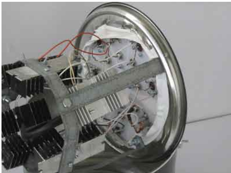
Visar kopplingen mellan kontakter och motstånd samt kylarna som används.
