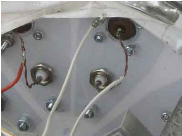
Visar hur de två kontakterna i samma modul är hopkopplade.
