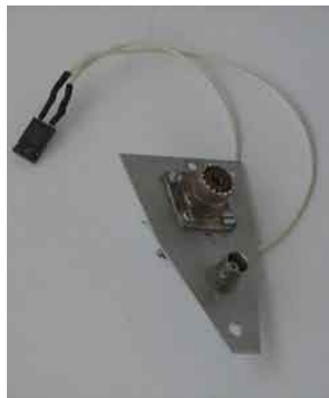
En modul med kontakter och motstånd löstagen från burkan och kylaren.
